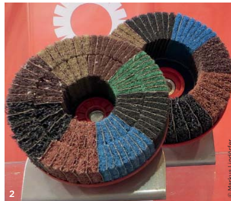
1 Lamellenbürsten eignen sich für ein ungerichtetes Finish.
